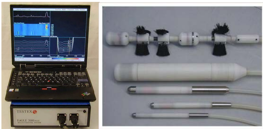
Kuva 4-13. RFET laitteisto putkiston tarkastukseen /Testex Incorporation/
