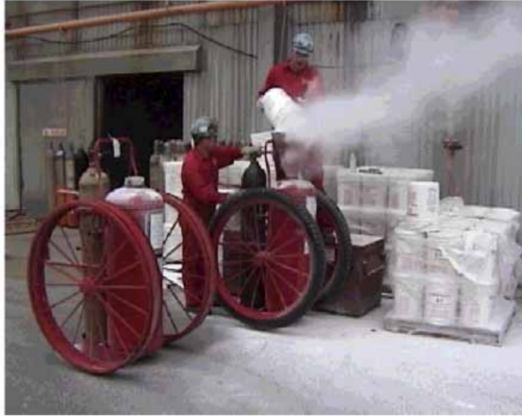
Kuva 36. Natriumbikarbonaatin säiliön täyttö.
