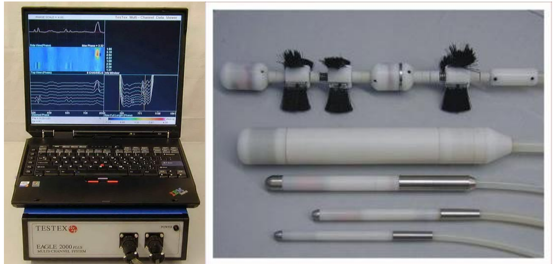
Kuva 4-13. RFET laitteisto putkiston tarkastukseen /Testex Incorporation/
