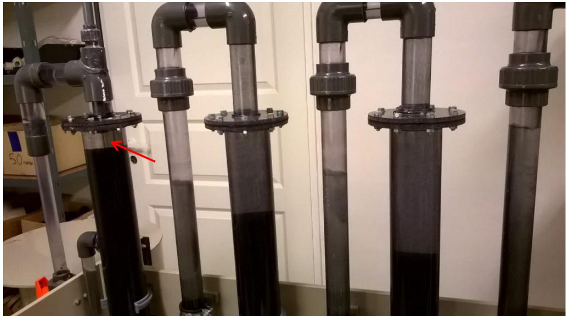
Kuva 7c. Lipeän syrjäytyminen (nuoli). Rajapinta pysyy selvänä myös muissa putkissa.
