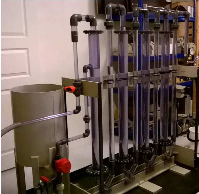
Kuva 3a. Koelaitteistoa (vasemmalla sakkalietteen syöttösäiliö)
