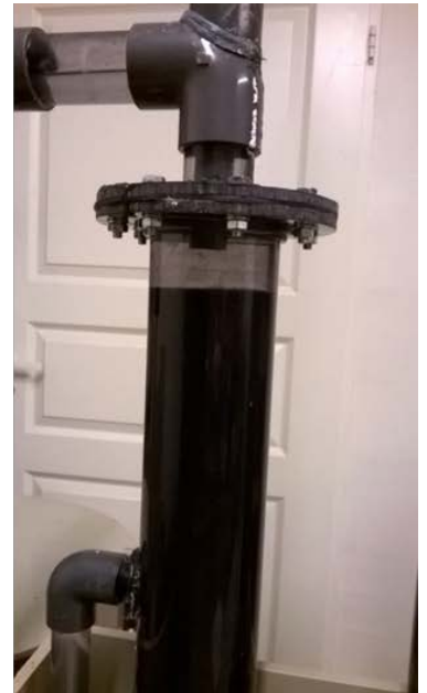
Kuva 8. Lipeän syrjäytys: rajapinta säilyy selvänä ja ehjänä syrjäytyksen edetessä.
