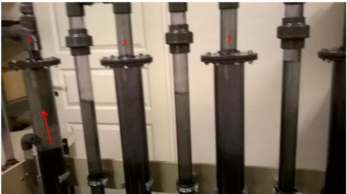
Kuva 7a. Lipeän syrjäytyminen. Kirkas kerros otetaan ulos putkesta no 1. (nuoli). Kirkastunut pesuvesi putkissa 2 - 4 siirtyy samalla aina seuraavaan putkeen vasemmalle.
