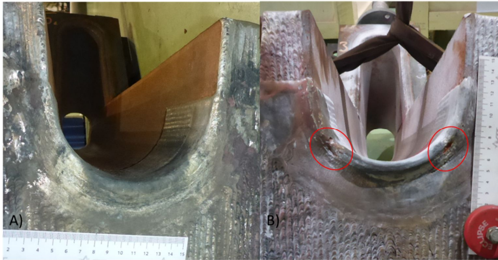
Kuva 139. Valmetin sulakourun jättöpääty a) jouhevampi jättöpinta, ja b) jyrkempi jättöpinta. Myös yleisimmät syöpymien ilmentymispaikat merkitty
