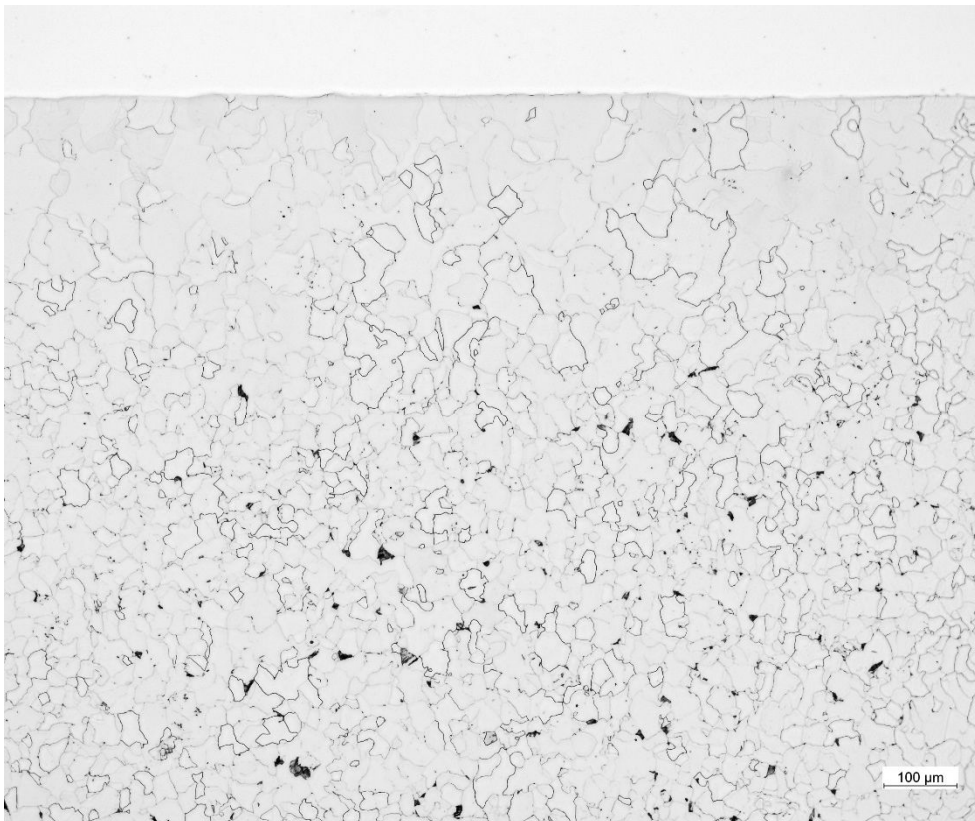
Kuva 17. Kaukopää SK5 pinnoite-perusaine rajapinta sulakourun seinämältä, perusaine syövytetty
