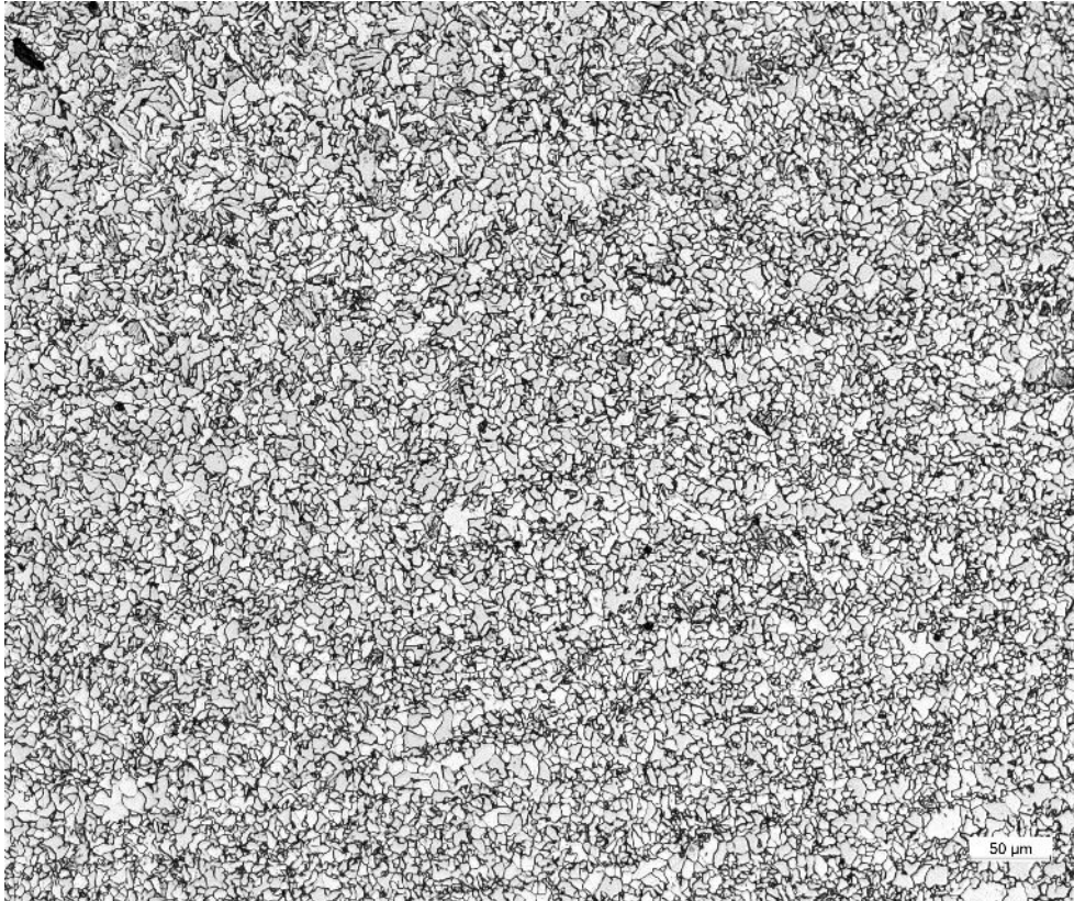
Kuva 117. Pietarsaari Y, perusaineen mikrorakenne kourun pohjalta (pitää ottaa uusi kuva, tämä osittain muutosvyöhykkeeltä)
