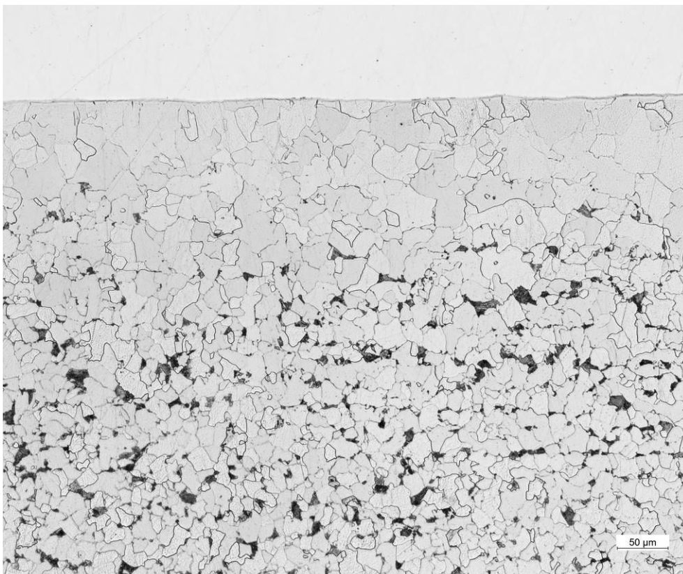
Kuva 129. Pietarsaaren uuden kourun pinnoite-perusainerajapinta kourun seinämältä
