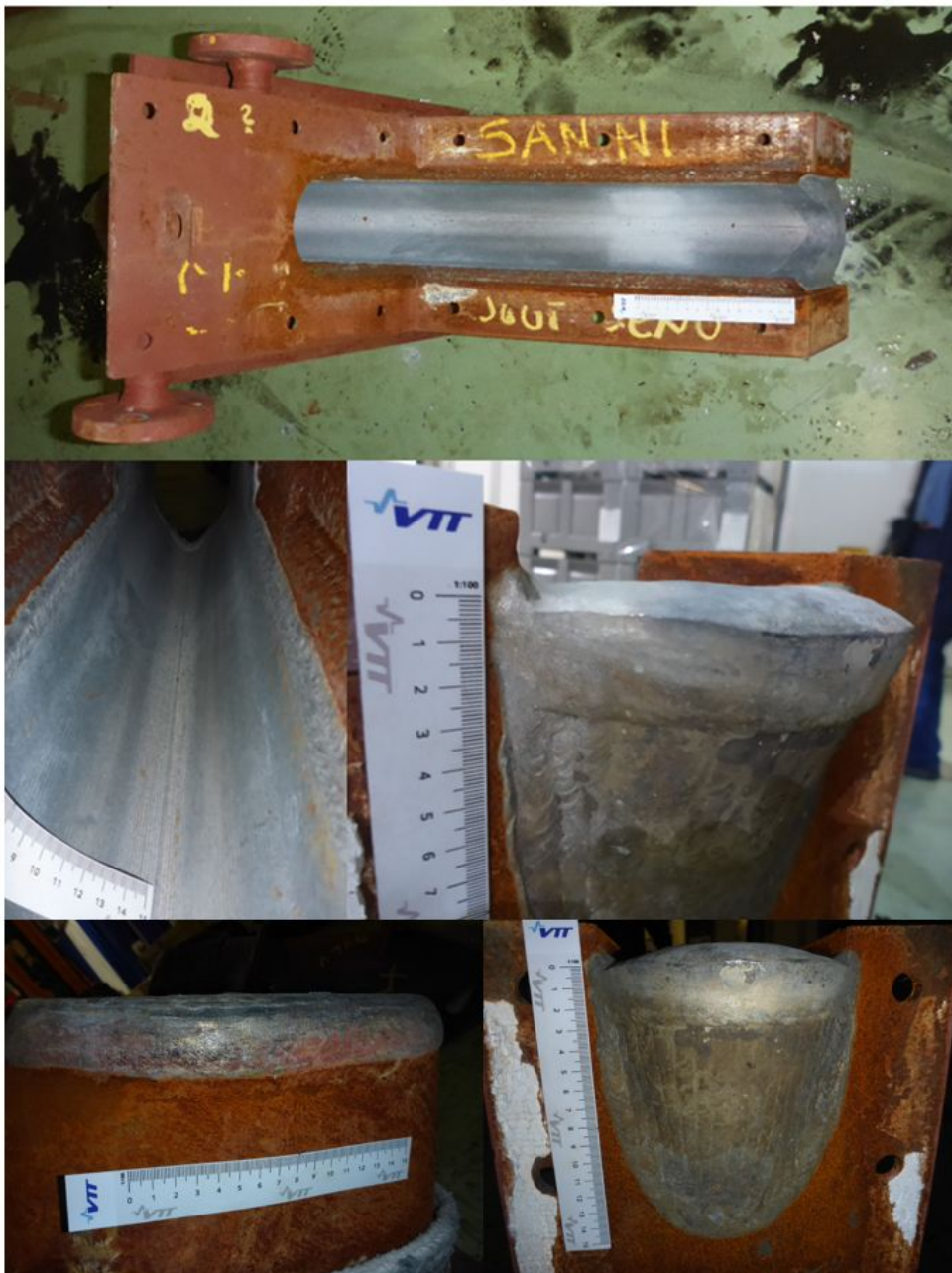
Kuva 3. Tutkimuksiin toimitettu sulakouru (Joutseno 2)
