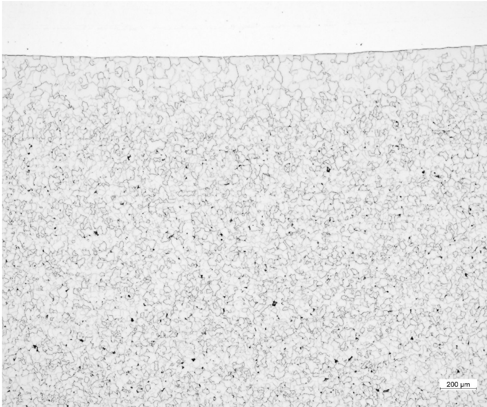
Kuva 11. Kaukopää SK5 pinnoite-perusaine rajapinta sulakourun pohjalta, perusaine syövytetty
