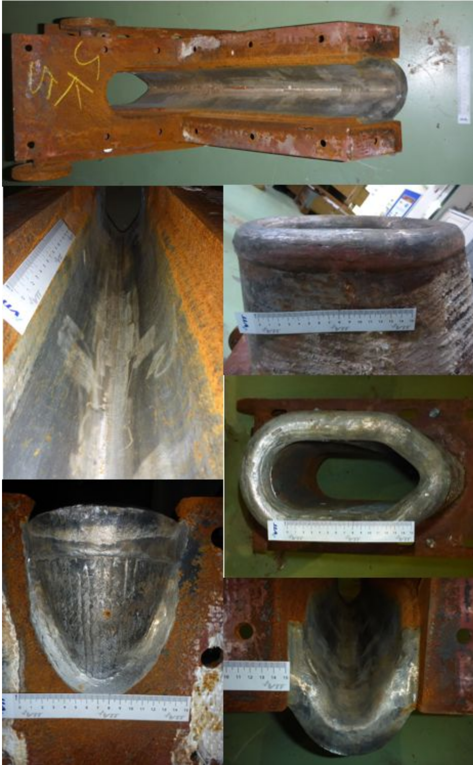
Kuva 7. Tutkimuksiin toimitettu kouru (Kaukopää SK5)
