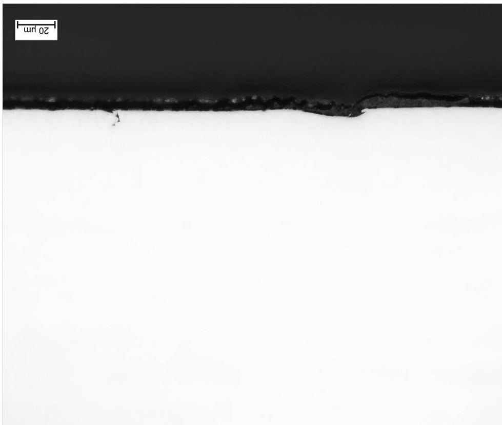
Kuva 12. Kaukopää SK5, ulkopinta kourun pohjalta, syövyttämätön näyte
