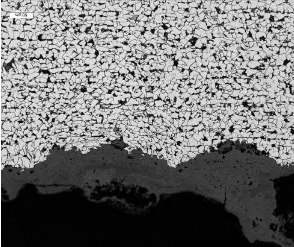
Kuva 10. Kemi 3 sisäpinnan pohjanäytteen oksidi
