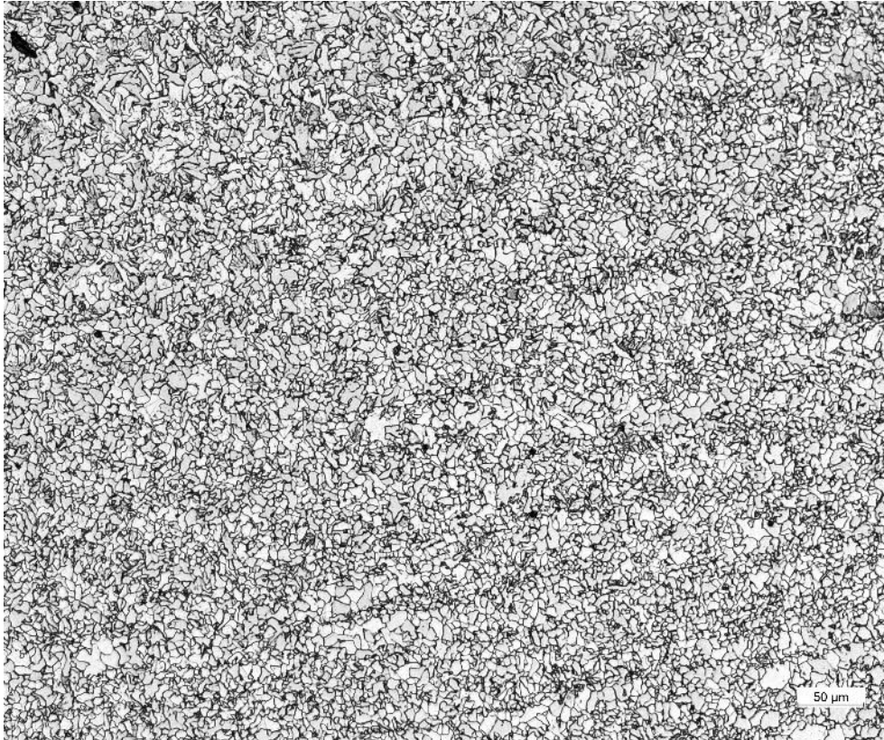
Kuva 86. Pietarsaari Y, perusaineen mikrorakenne kourun pohjalta (pitää ottaa uusi kuva, tämä osittain muutosvyöhykkeeltä)
