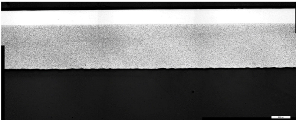
Kuva 96. Pietarsaaren uuden sulakourun poikkileikkaus seinämältä
