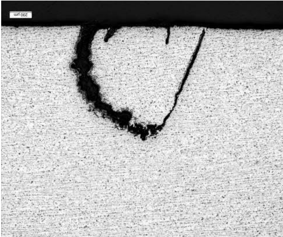
Kuva 25. Kemi 5 särö kourun pohjan ulkopinnalla
