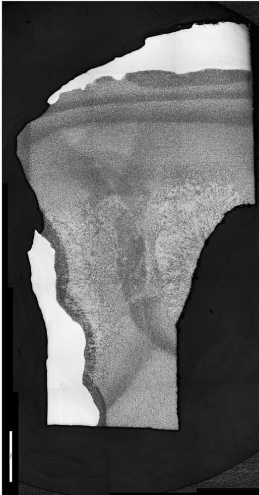
Kuva 16. Kemi 3 sulakourun jättöpään poikkileikkaus
