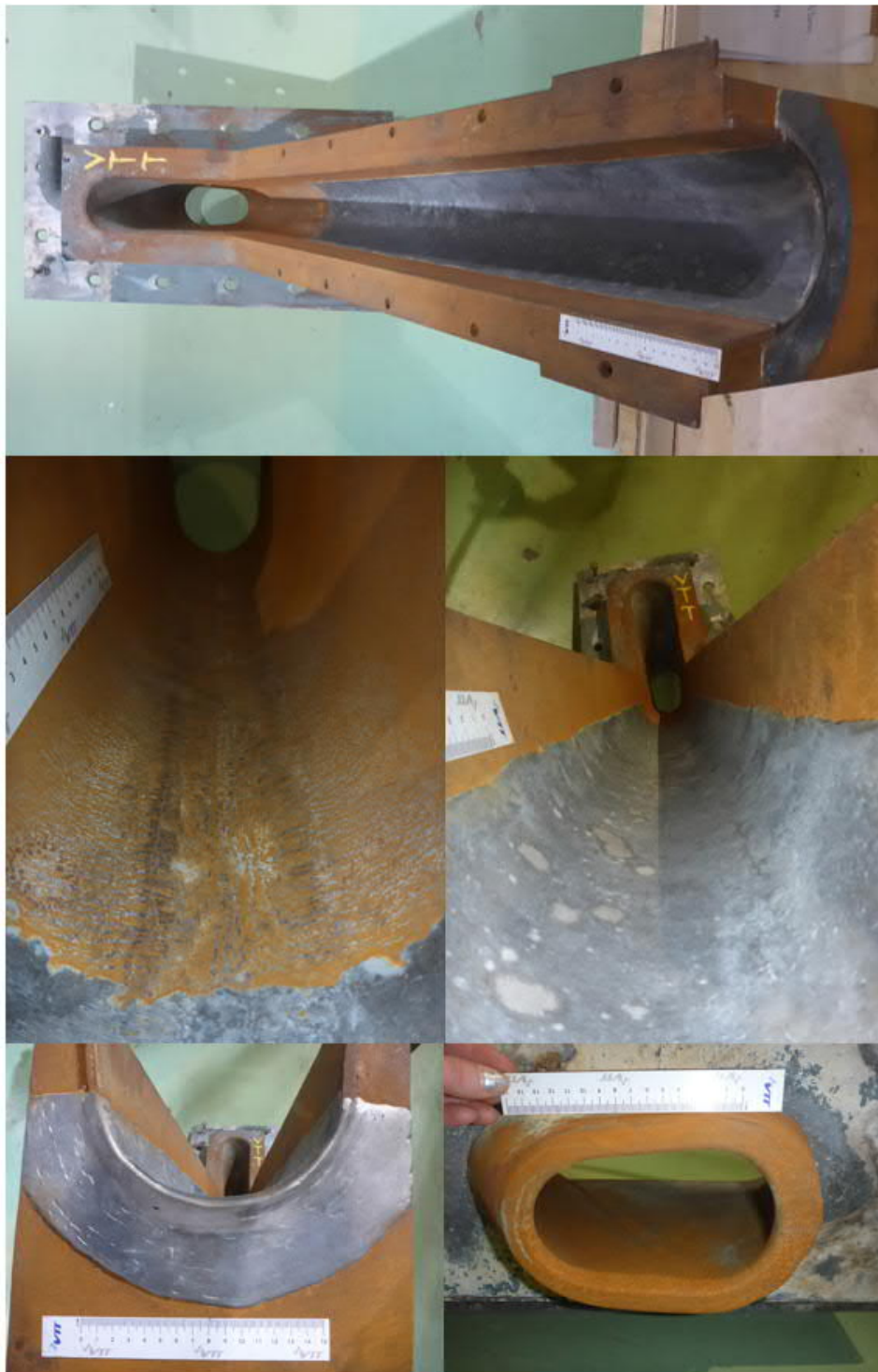
Kuva 100. Tutkimukseen toimitettu ränni (Sunila SK10)
