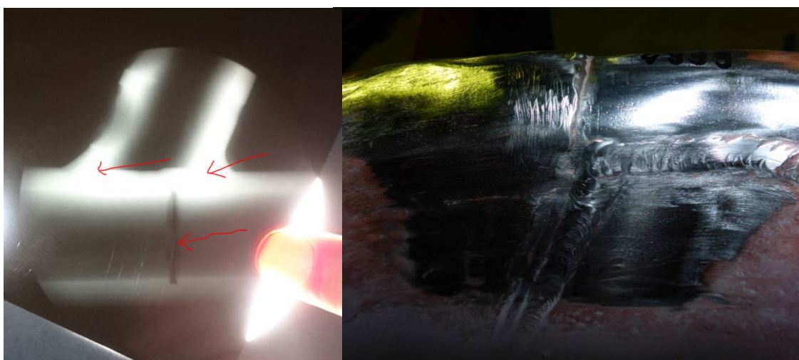
Kuva 4-2. Vasemmalla: esimerkki röntgenkuvasta, jossa näkyy sisäpuolen vajaa juuri. Oikealla: esimerkki valmistusenaikaisista hitsausvirheistä, mm. jyrkät liittymät näkyvät selvästi
