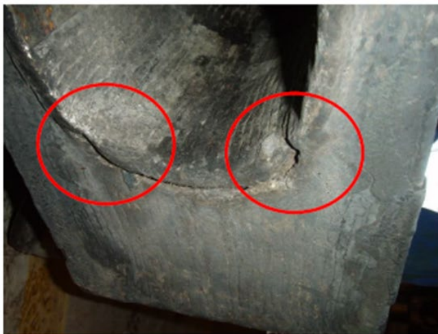
Kuva 7-1. Esimerkki jättöreunan syöpymisestä
