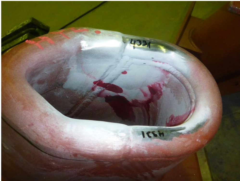
Kuva 6-4. Esimerkki pintatarkastuksessa havaituista vioista.
