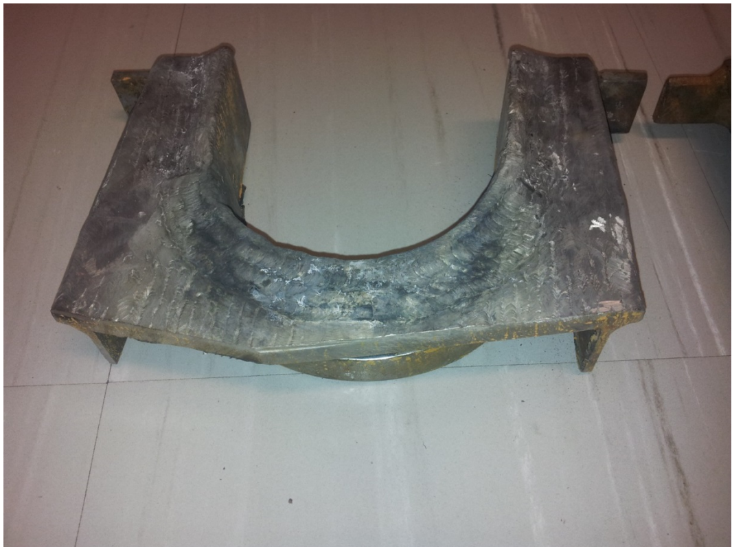
Kuva 6-3. 1 ½ vuotta kattilassa ollut pinnoitettu ränni
