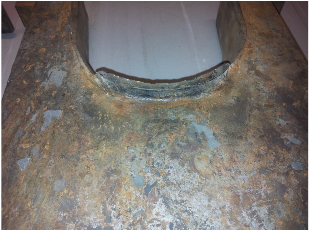
Kuva 6-2. Vuoden kattilassa ollut pinnoittamaton ränni
