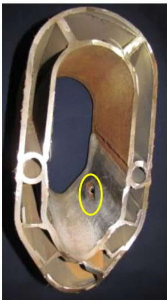
Figur 8 Hål i en ränna cirka 1 dm in, räknat från smältainloppet
