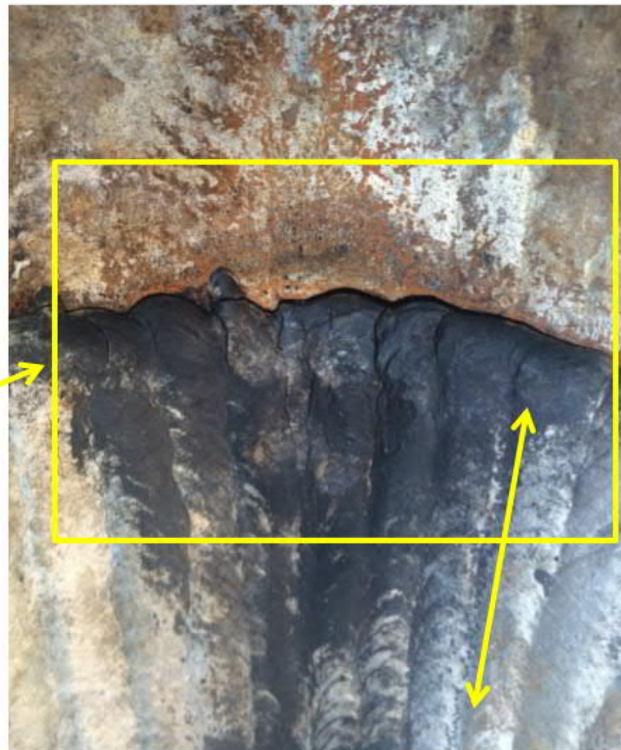
Figur 4... hade grövre strängar av påsvetsning längs med rännan
