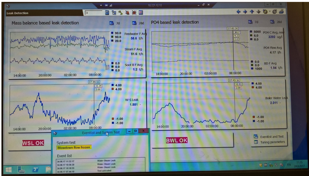
Kuva 21. Valmetin vuodonvalvontajärjestelmän näyttö Maglajin tehtaalla, vasemmalla puolella syöttövesi-höyryeron ja oikealla kattilavesivuodon trendit testin ajalta
