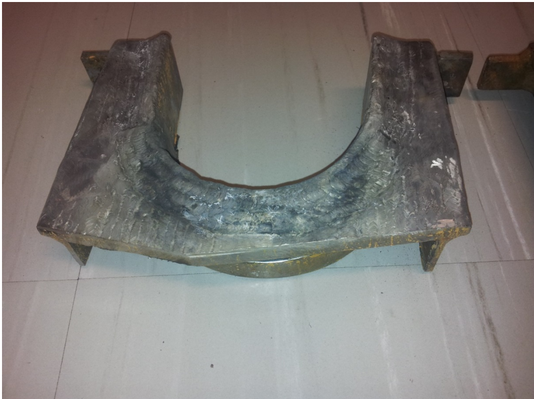
Kuva 6-3. 1 ½ vuotta kattilassa ollut pinnoitettu ränni
