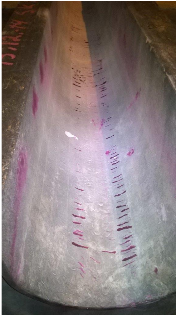
Kuva 4-2. Tunkeumanestetarkastuksessa havaittuja säröjä
