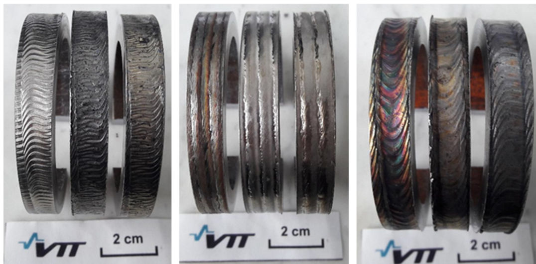
Kuva 1. Hitsauspinnoitetut näyteputket. Vasemmalta oikealle AZZ, Uhlig ja AREVA
