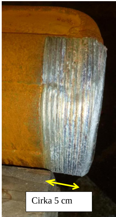
Figur 16 Detta fotografi är taget underifrån löprännan vid smältautloppet för att visa att den är korrosionsskyddad även cirka 5 cm på underkanten eftersom smältan inte släppte
