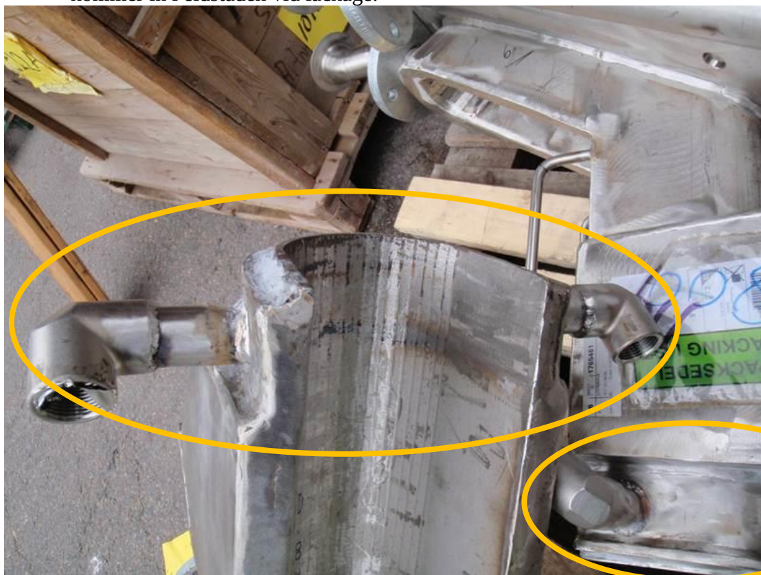
Figur 1 Panna M och Panna N använder ett extra kylsystem cirka den nedersta decimetern
