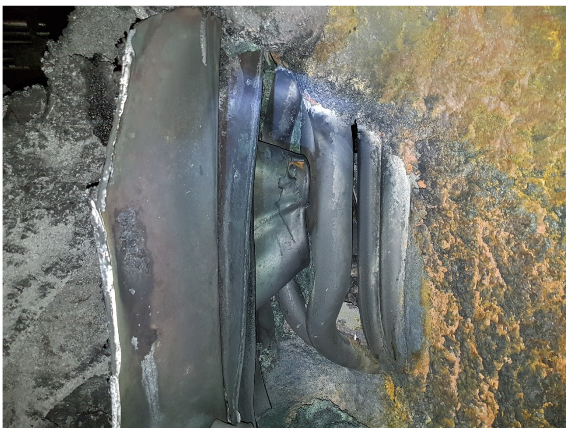
Kuva 2-2. Räjähdysten voimasta irronnut ränni
