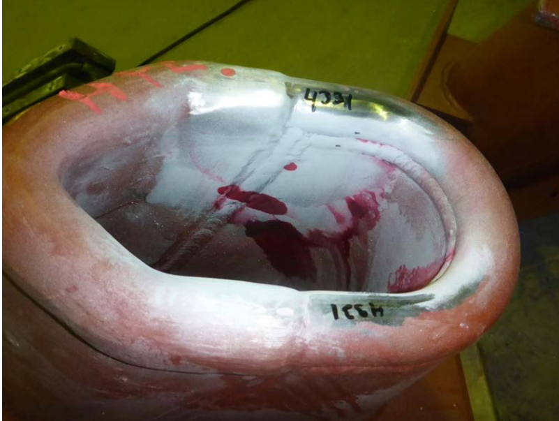
Kuva 7-3. Esimerkki pintatarkastuksessa havaituista vioista.
