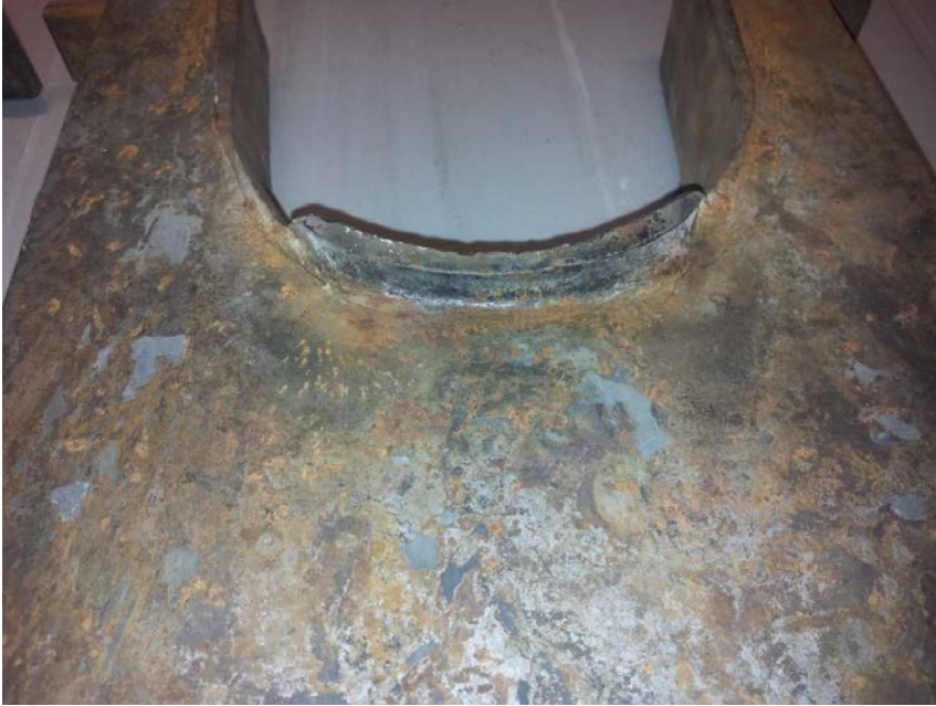
Kuva 7-1. Vuoden kattilassa ollut pinnoittamaton ränni
