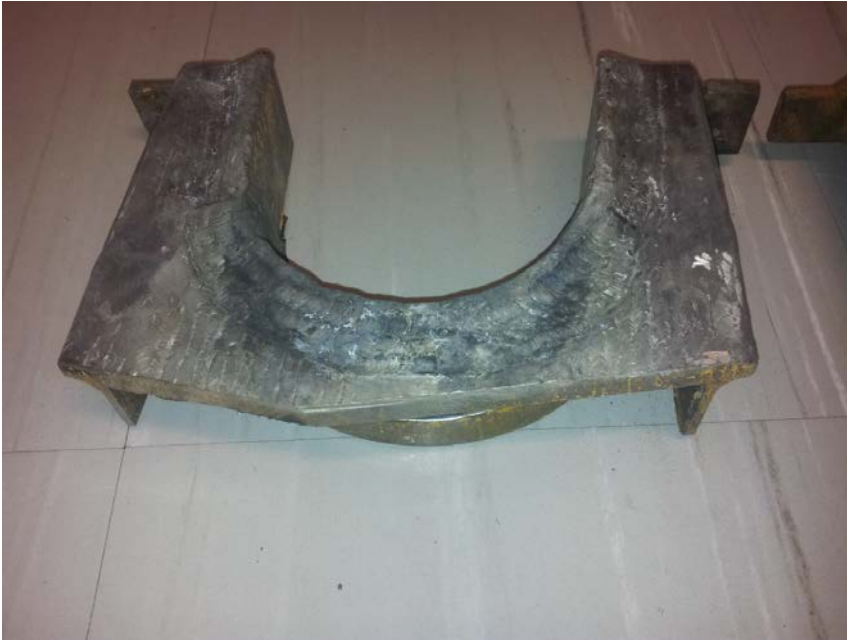
Kuva 7-2. 1 ½ vuotta kattilassa ollut pinnoitettu ränni
