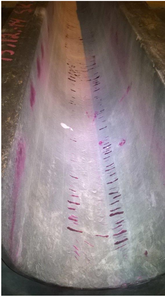
Kuva 3-2. Tunkeumanestetarkastuksessa havaittuja säröjä
