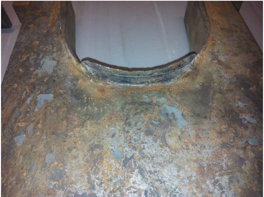
Kuva 7-1. Vuoden kattilassa ollut pinnoittamaton ränni
