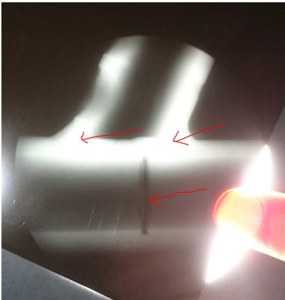
Kuva 7-3. Esimerkki röntgenkuvasta, jossa näkyy sisäpuolen vajaa juuri.
