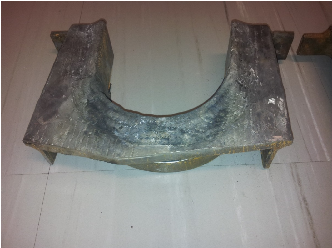
Kuva 7-2. 1 ½ vuotta kattilassa ollut pinnoitettu ränni
