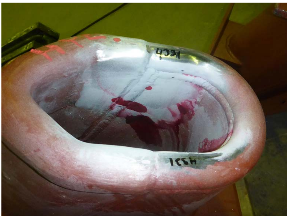
Kuva 7-4. Esimerkki pintatarkastuksessa havaituista vioista.
