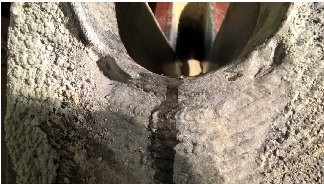
Kuva 3-1. Esimerkki jättöreunan syöpmisestä
