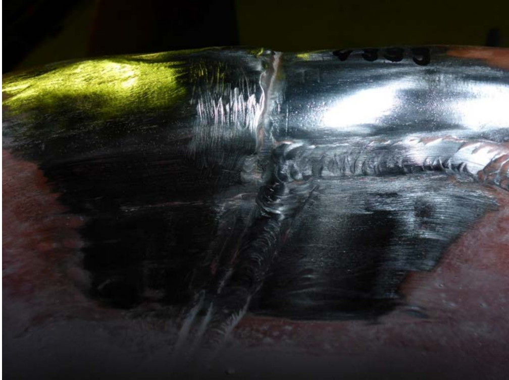
Kuva 7-5. Esimerkki valmistuksenaikaisista hitsausvirheistä, mm. jyrkät liittymät näkyvät selvästi
