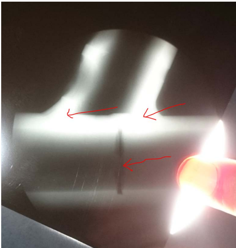
Kuva 5-7. Esimerkki röntgenkuvasta, jossa näkyy sisäpuolen vajaa juuri.
