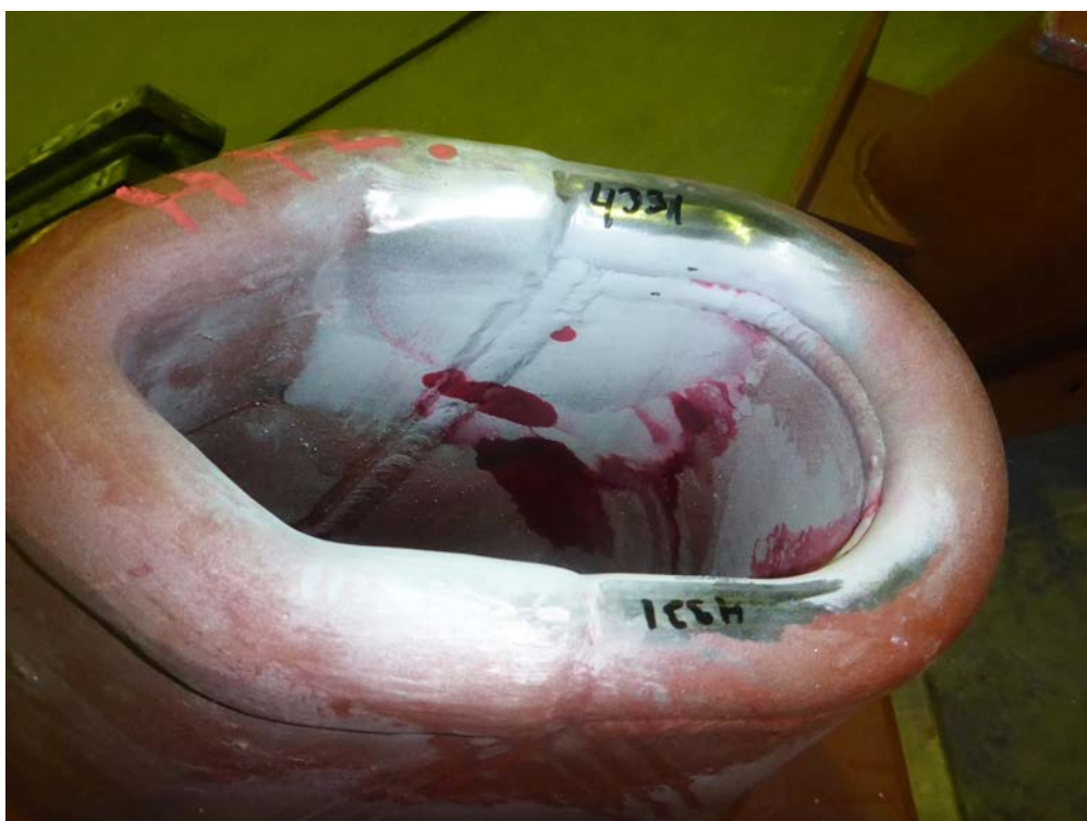
Kuva 5-8. Esimerkki pintatarkastuksessa havaituista vioista.
