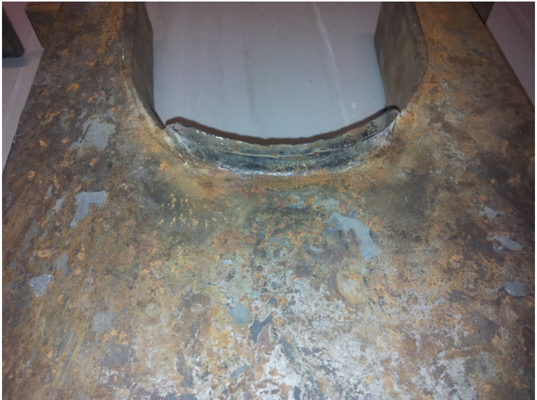
Kuva 5-5. Vuoden kattilassa ollut pinnoittamaton ränni
