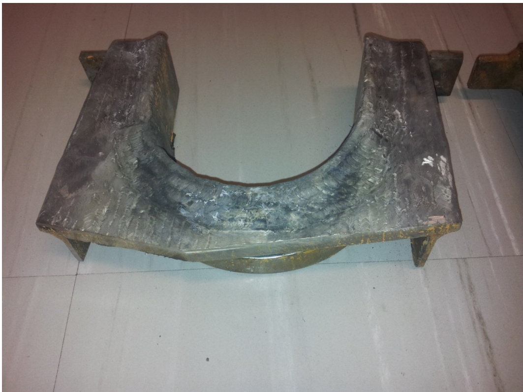
Kuva 5-6. 1 ½ vuotta kattilassa ollut pinnoitettu ränni
