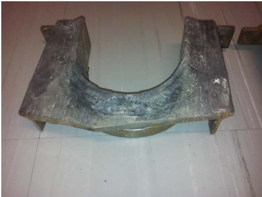
Kuva 5- 6 . 1 ½ vuotta kattilassa ollut pinnoitettu ränni
