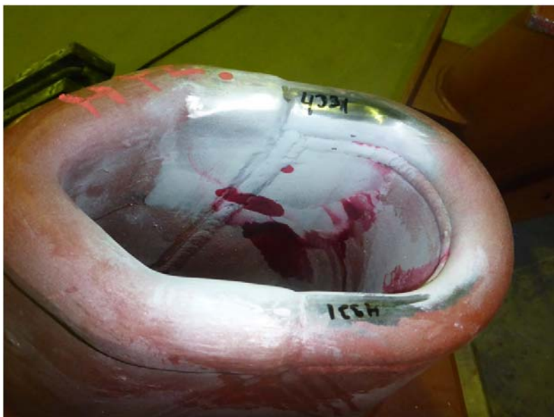
Kuva 5-8. Esimerkki pintatarkastuksessa havaituista vioista.
