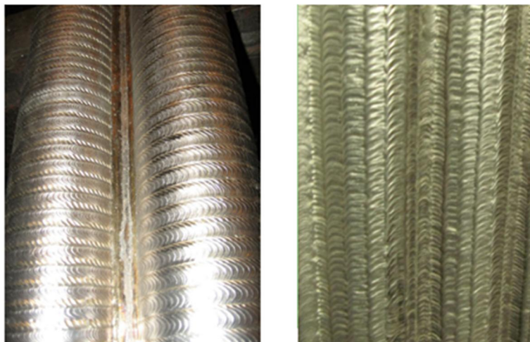
Kuva 2. Esimerkkejä hitsauspinnoitteista, vasemmassa kuvassa spiraalihitsi [13]
