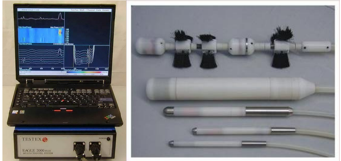
Kuva 4-13. RFET laitteisto putkiston tarkastukseen /Testex Incorporation/
