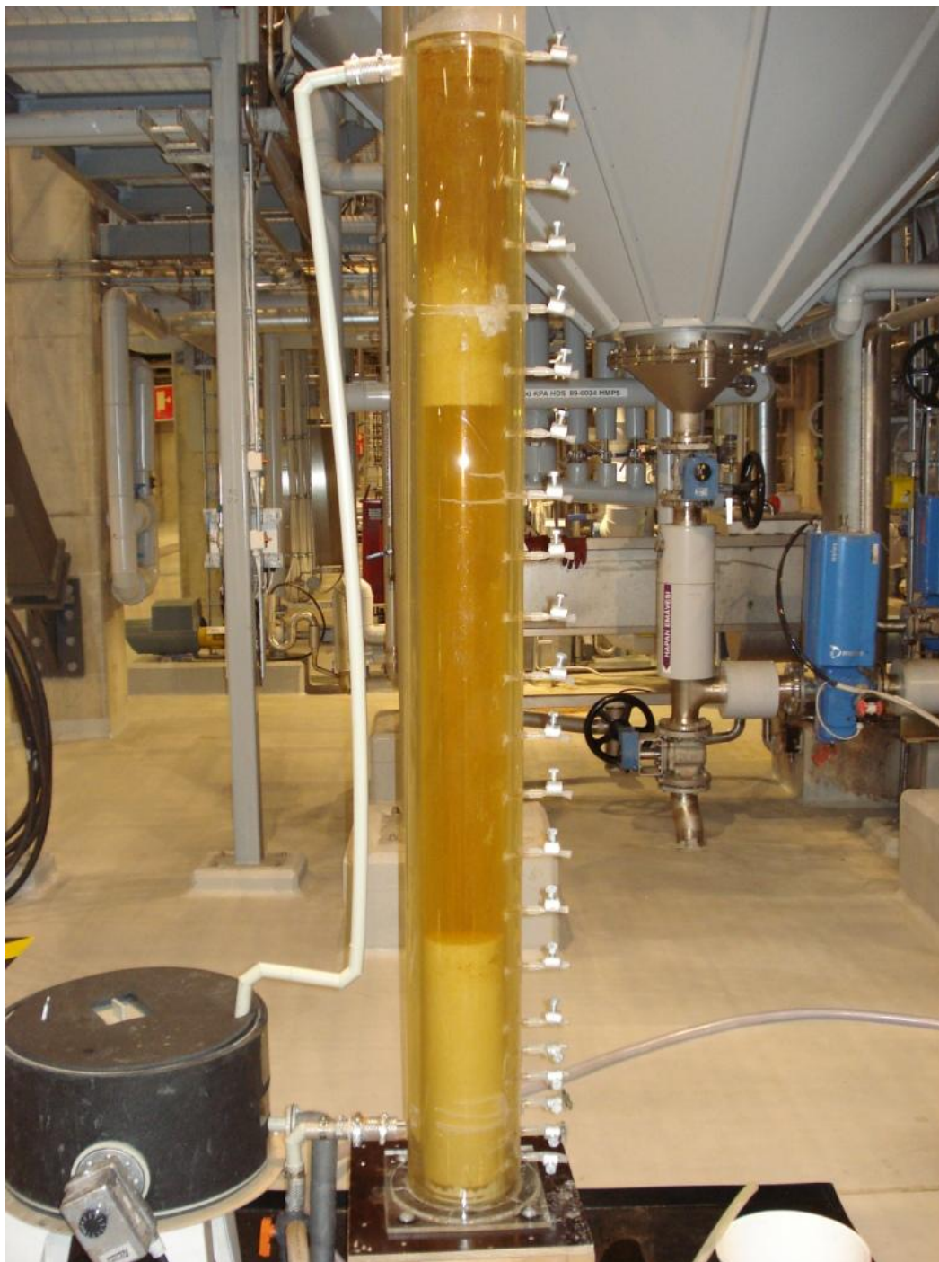
Kuva 3. Erottumisnopeuden tutkimuksiin käytetty laitteisto käytössä tehtaalla B.
