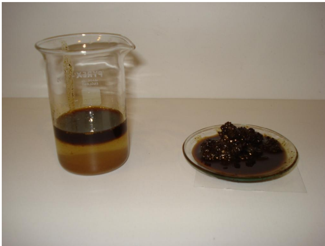
Kuva 21. Ligniinilautasta muodostunut öljy ja ligniini-kipsipuuro.
