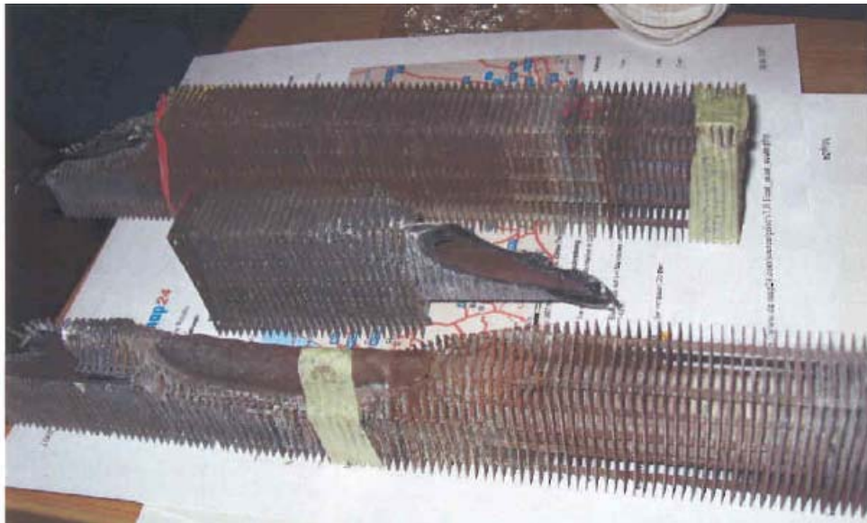
Kuva 1. Vaurioselvitykseen lähetetyt lämmönsiirtimen höyryputkinäytteet
