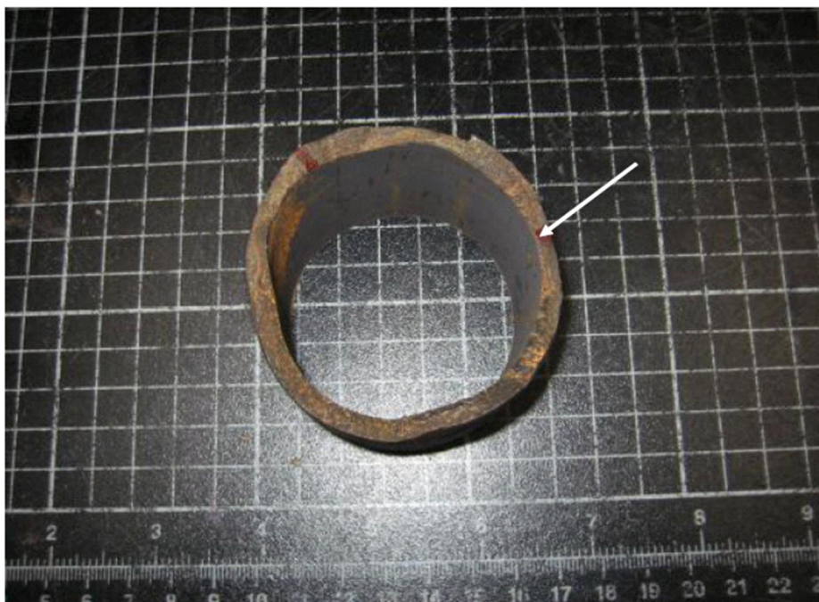
Bild 3 Makrofoto av brottyta. Brottet har startat i det godsfortunnade området till höger (se markering med pil). Större delen av brottytan utgörs av ett restbrott.
