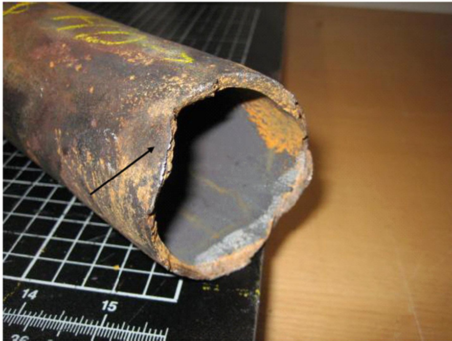
Bild 2 Brotttyta. Tydlig deformation och godsfortunning till vänster, se pil.
