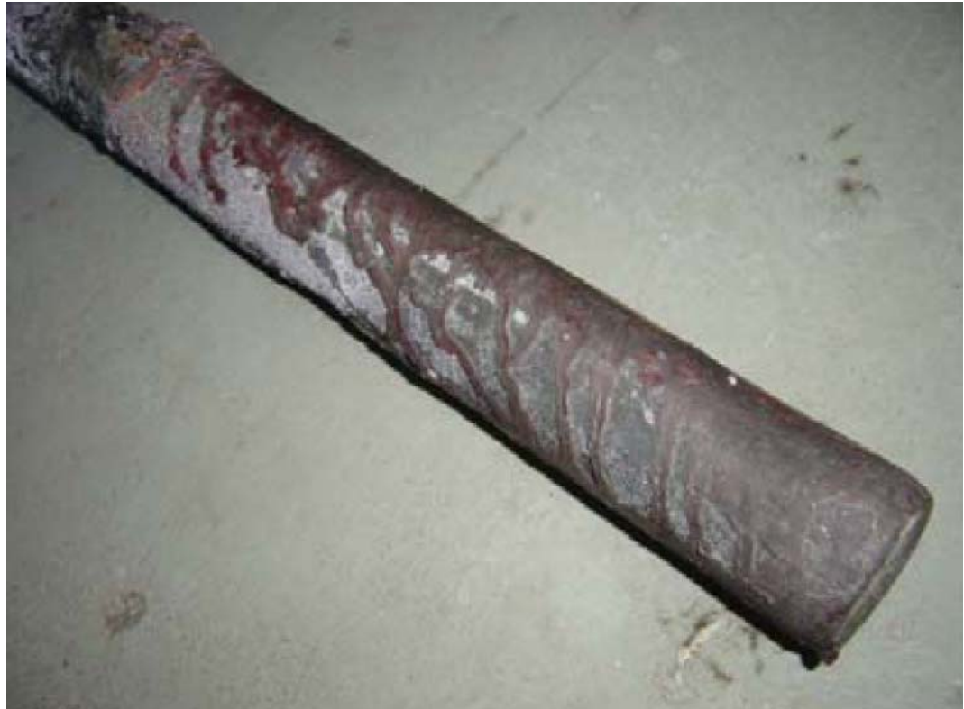
Kuva 8-11. Lappeenrannan koesondi lyhyen kokeen jälkeen.
