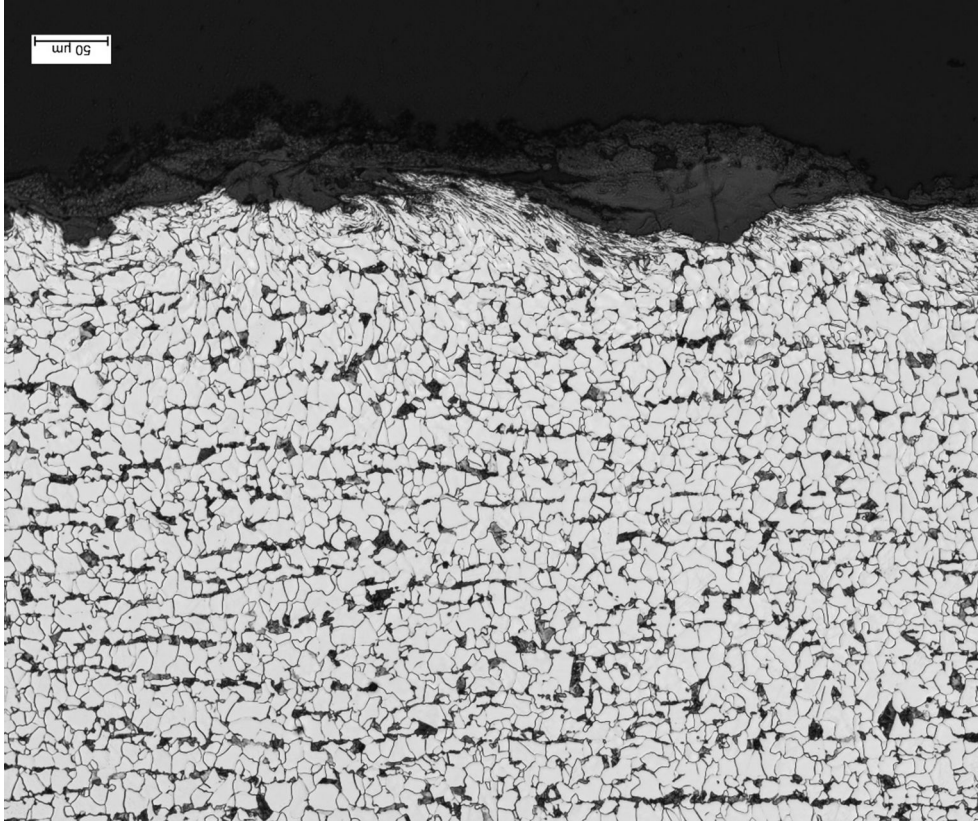
Kuva 23. Kaukopää SK6, ulkopinnan kerrostumaa kourun pohjalla
