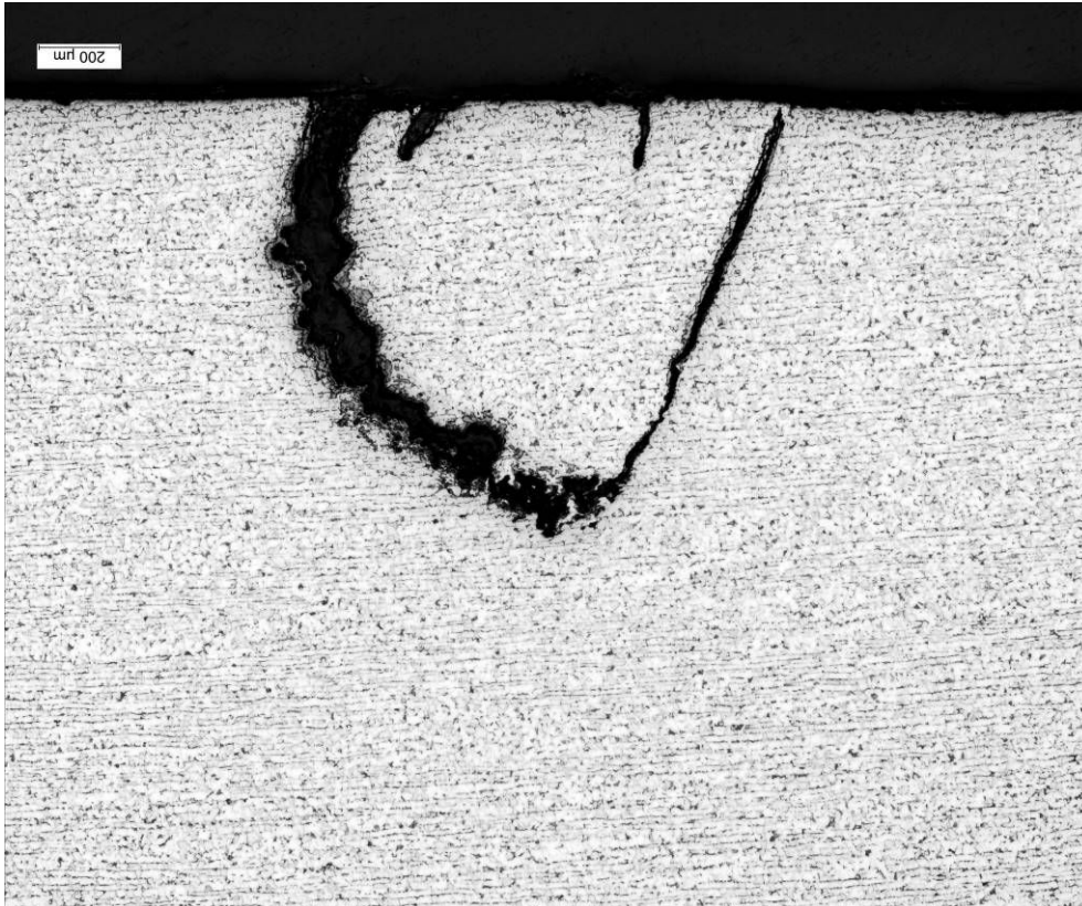
Kuva 53. Kemi 5 särö kourun pohjan ulkopinnalla
