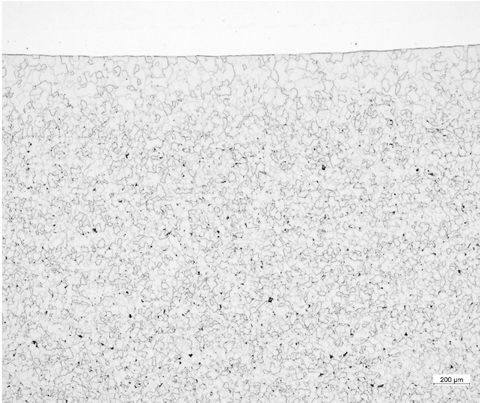
Kuva 11. Kaukopää SK5 pinnoite-perusaine rajapinta sulakourun pohjalta, perusaine syövytetty
