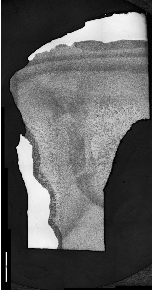
Kuva 44. Kemi 3 sulakourun jättöpään poikkileikkaus
