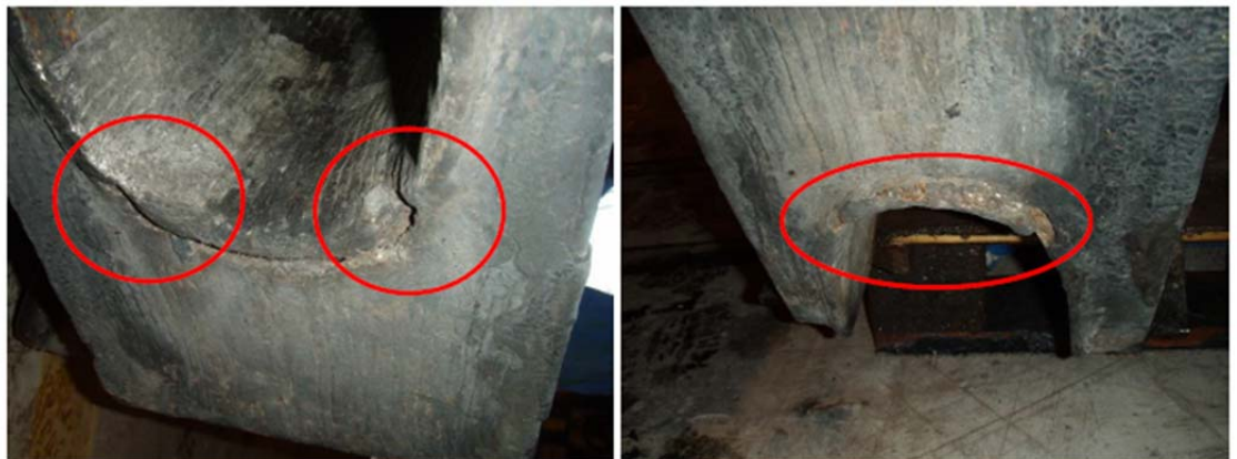
Kuva 6-1. Esimerkki jättöreunan syöpmisestä
