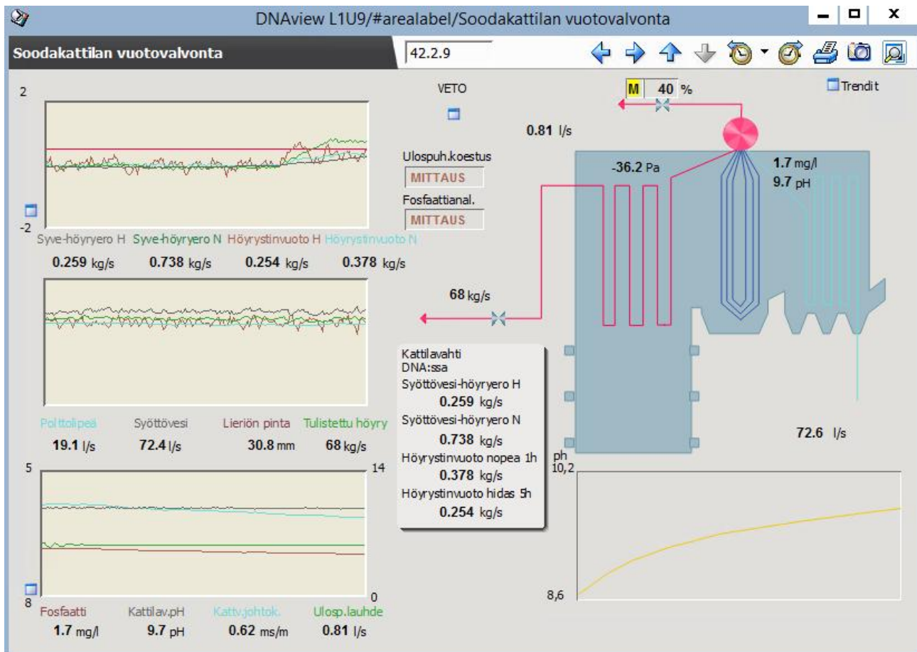
Kuva 18. Syöttövesi-höyryeron testaus Veitsiluodon soodakattilassa (tilanne testin päätyttyä)
