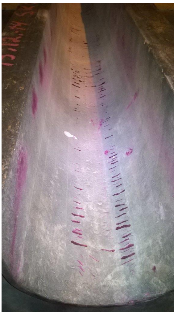
Kuva 4-2. Tunkeumanestetarkastuksessa havaittuja säröjä
