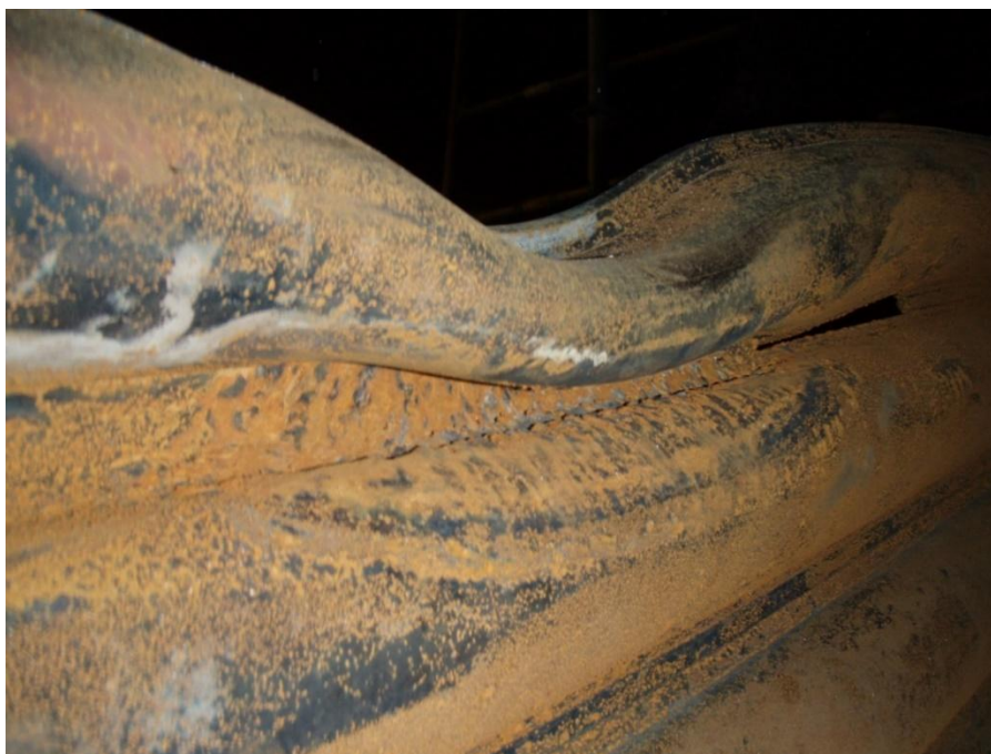
Kuva 15. Verhoputkivuoto MF Rauman soodakattilassa 2011
