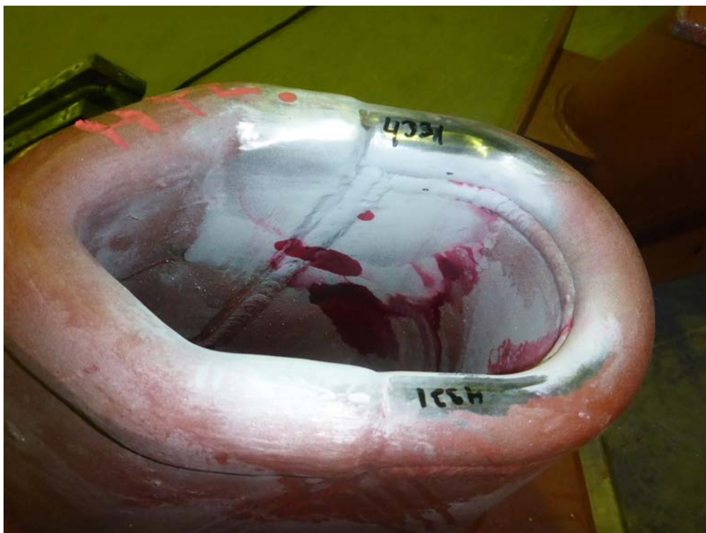
Kuva 7-3. Esimerkki pintatarkastuksessa havaituista vioista.
