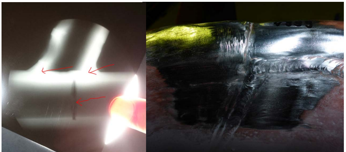
Kuva 4-1. Vasemmalla: esimerkki röntgenkuvasta, jossa näkyy sisäpuolen vajaa juuri. Oikealla: esimerkki valmistusenaikaisista hitsausvirheistä, mm. jyrkät liittymät näkyvät selvästi
