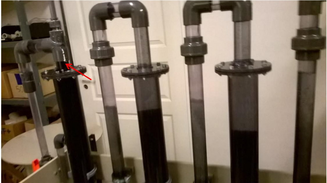
Kuva 7d. Syrjäytys pysäytetään kun rajapinta on saavuttanut ulostuloputken suun.
