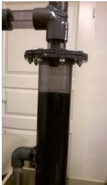
Kuva 8. Lipeän syrjäytys: rajapinta säilyy selvänä ja ehjänä syrjäytyksen edetessä.
