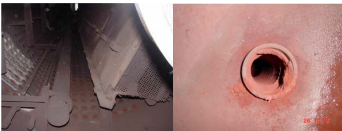
Kuva L2. Lieriössä epäpuhtauksia ja värimuutoksia
