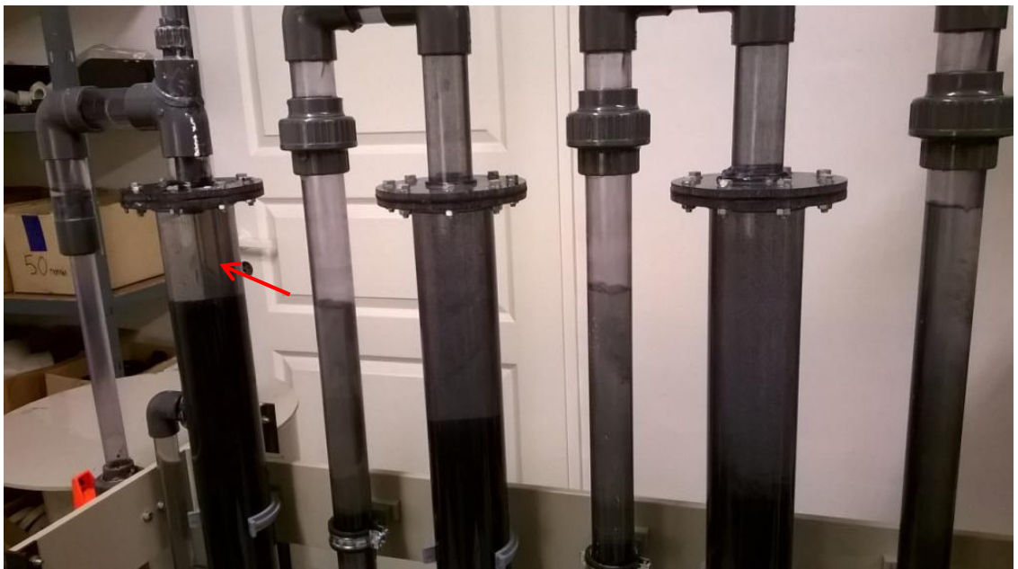
Kuva 7b. Lipeän syrjäytyminen. Musta kerros liikkuu ylöspäin kaikissa putkissa.
