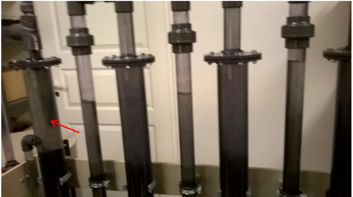
Kuva 7a. Lipeän syrjäytyminen. Kirkas kerros otetaan ulos (nuoli). Kirkastunut pesuvesi putkissa 2 - 4 siirtyy samalla aina seuraavaan putkeen vasemmalle.
