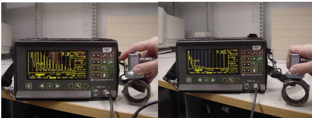
Kuva 4-10. A-näytöt ehjästä putkesta ja vetyhyökkäyskohdalta.
