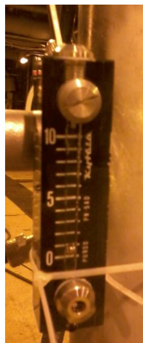
Kuva 39. Vasemmalla: kokeissa käytetyn vetyperoksidin kemikaalisäiliö. Oikealla: annostelun säädössä käytetty rotametri.
