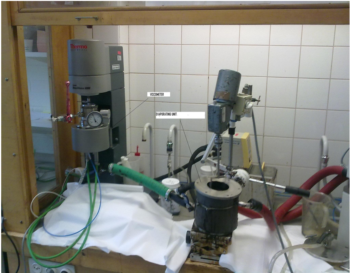
Kuva 3. Viskositeettimäärittämiseen käytetty laitteisto kokonaisuudessaan
