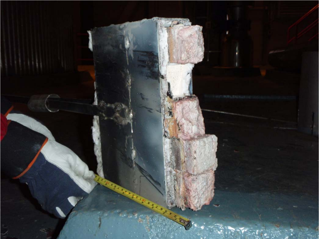
Kuva 5. \text{ZrO}_2 massa ei ole makaanisesti kovin luja ja murtui kehikkoa irrotettaessa ekaa kertaa. Kaksi alinta massaa hassle ja betker näyttävät hyviltä.
