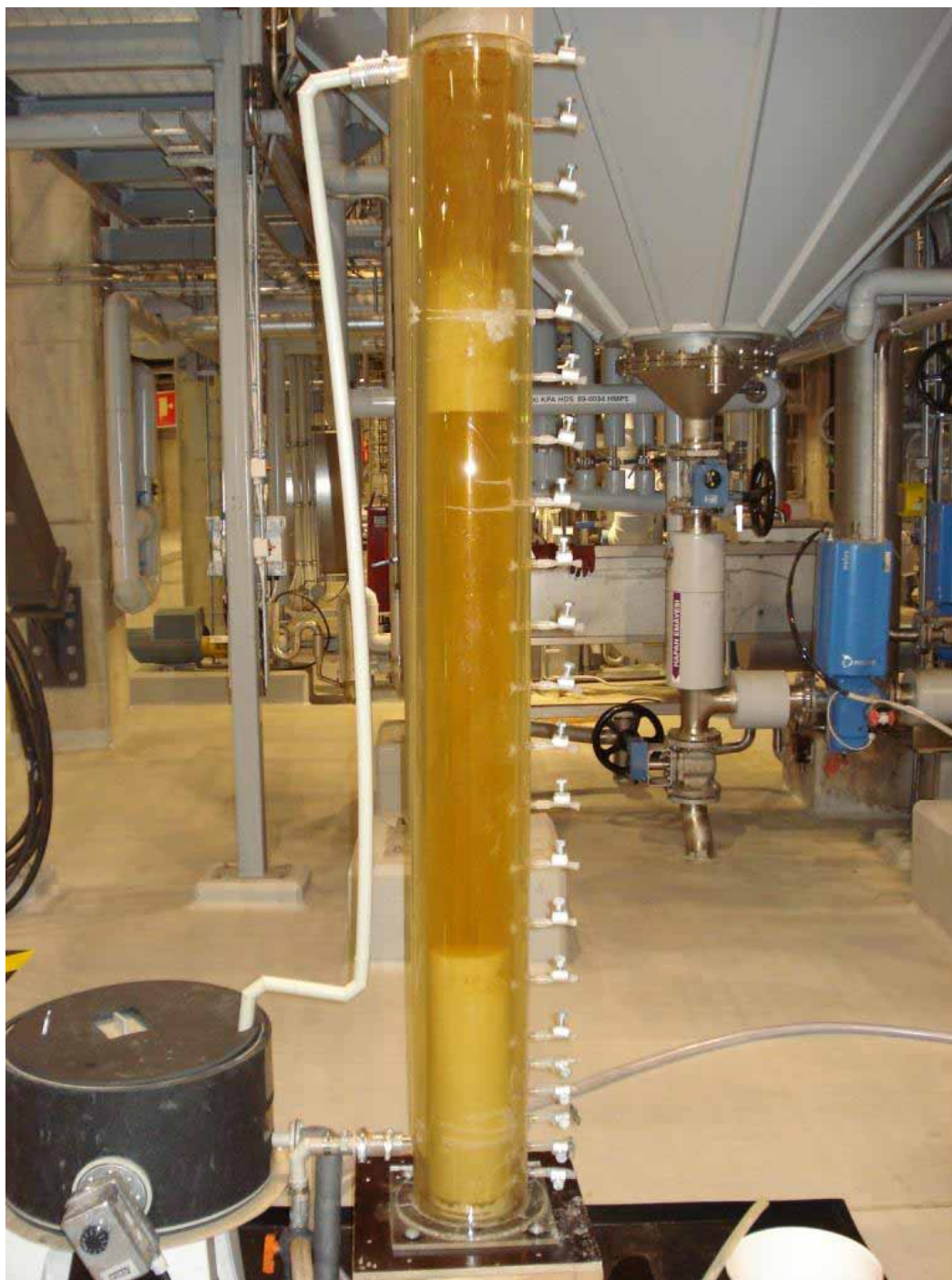
Kuva 3. Erottumisnopeuden tutkimuksiin käytetty laitteisto käytössä tehtaalla B.
