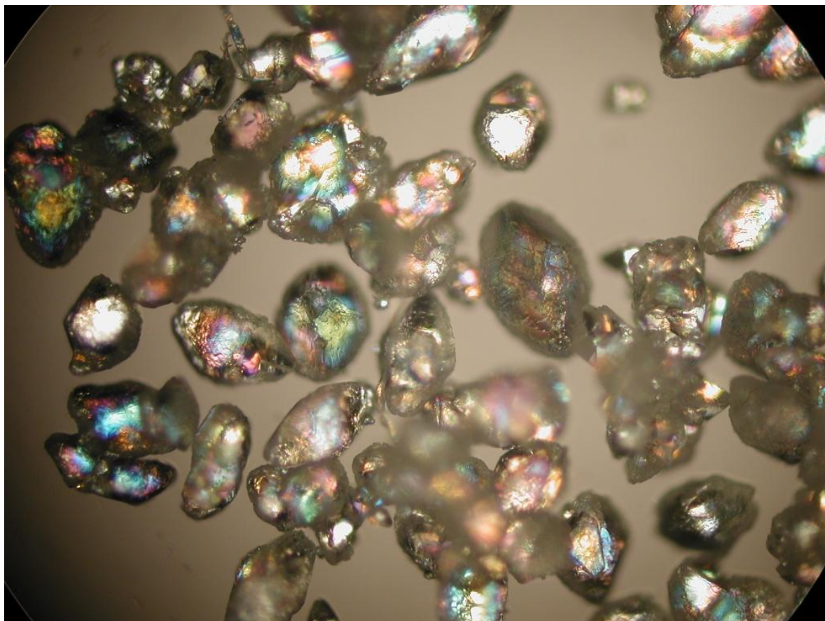
Kuva 12. Tehdas A. Kiteytyksen loppuvaihe. Kuluneita kiteitä. Vesi/suolasuhde 0,44.
