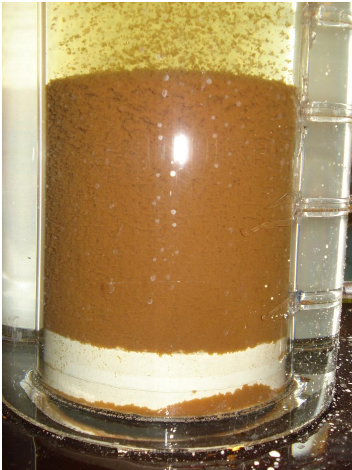
Kuva 6. Pohjaosa, 1h 30 min. Sakkakerroksen tilavuus 6 %.
