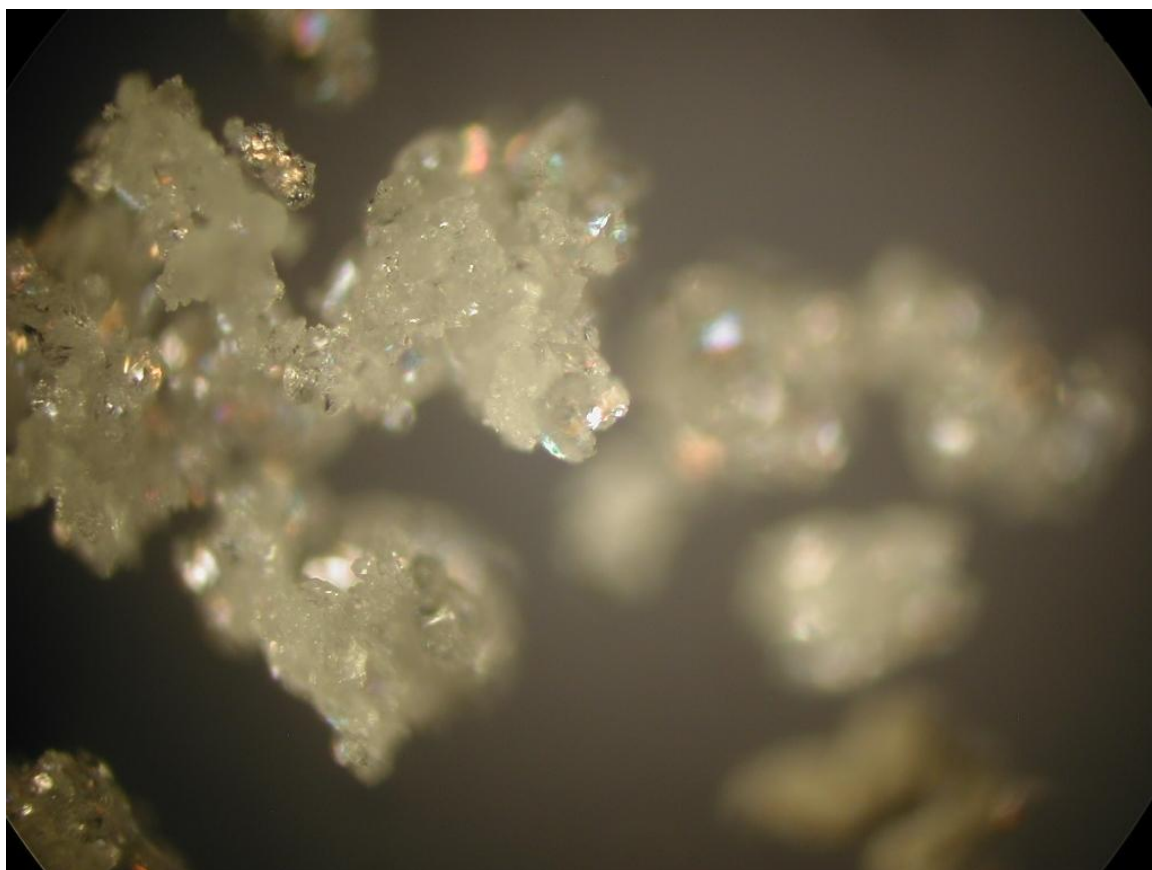
Kuva 14. Tehdas B, kiteytyksen keskivaihe, vesi/suolasuhde 1,02.
