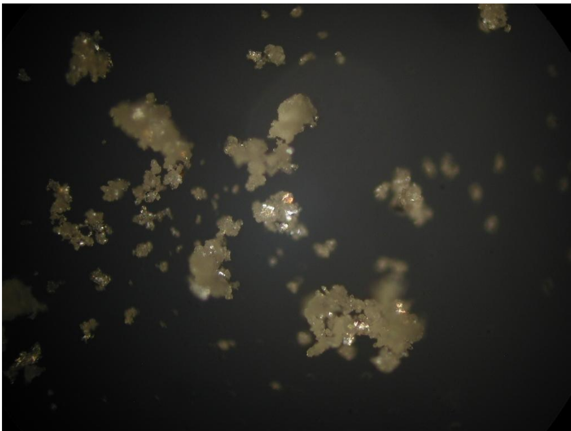
Kuva 15. Tehdas B, loppuvaihe, vesi/suolasuhde 0,8. Ei polarisoivaa faasia.
