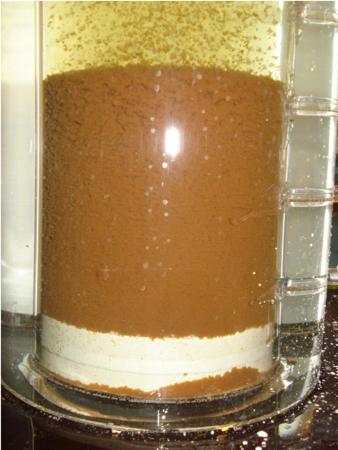
Kuva 6. Pohjaosa, 1h 30 min. Sakkakerroksen tilavuus 6 %.
